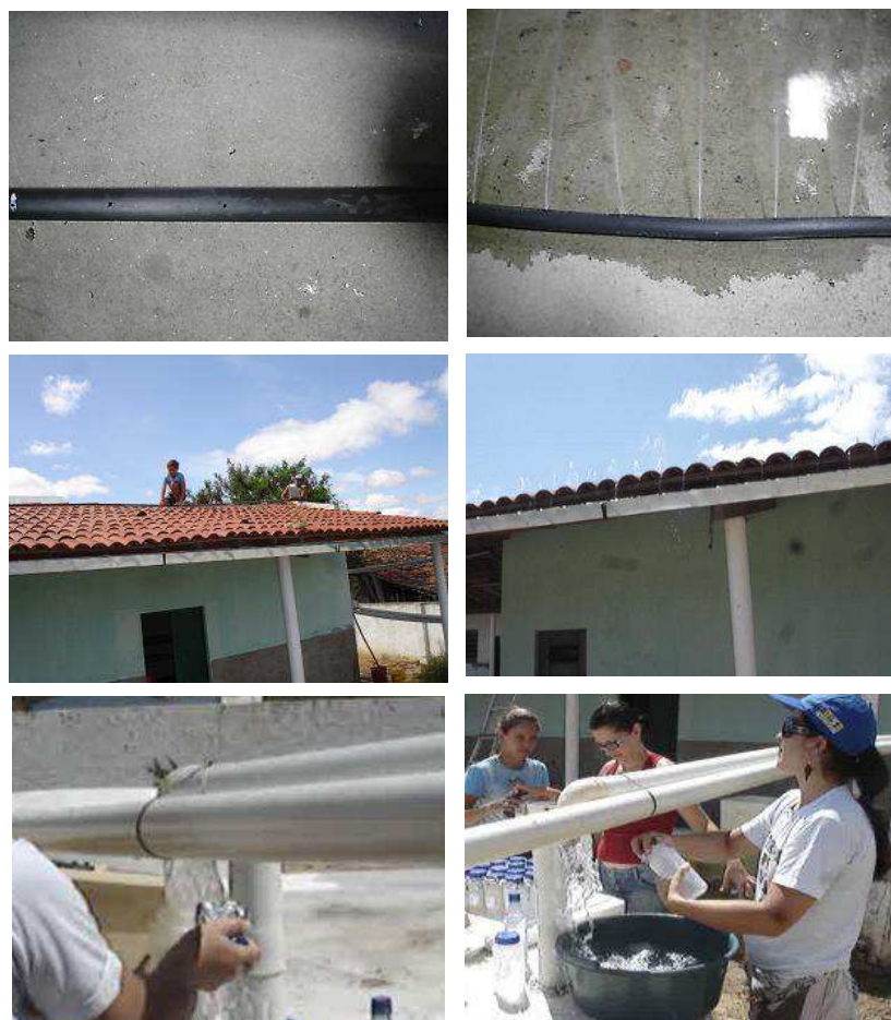
Figura 33. Etapas do experimento da simulação de chuva para avaliação dos desvios
