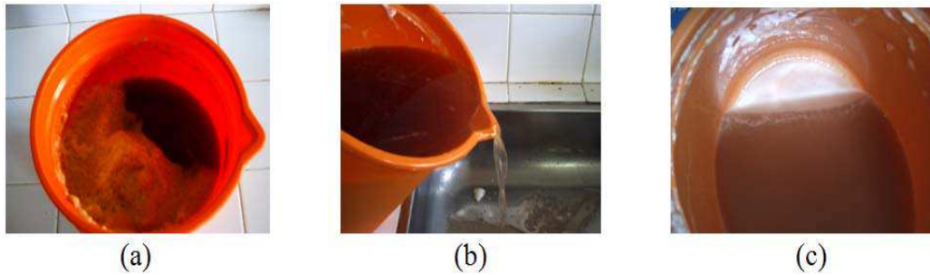
Figura 3.10- Descarte do sobrenadante após a primeira decantação: (a) parte da mucilagem presente nos tubérculos, (b) descarte da solução de NaOH juntamente com a mucilagem e (c) precipitado decantado (amido) no recipiente
