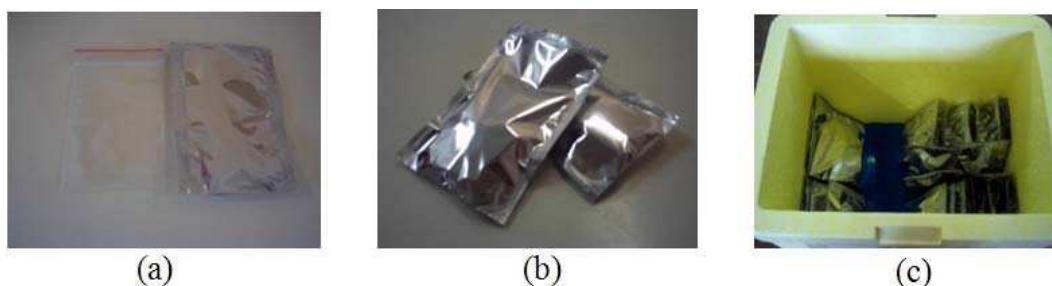
Figura 3.16- Embalagem do amido seco: (a) saco de polietileno com fechamento “zip lock” (à esquerda) e embalagem de plástico metalizado (à direita), (b) porções de amido já embaladas e (c) caixa de poliestireno expandido para o armazenamento do amido
