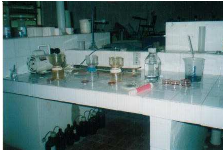
Figura 3.4 - Sistema de filtração pelo Método da Membrana Filtrante. Fonte: Direta, (2006).
