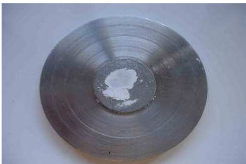
Figura 3.7 - Pastilha feita a partir do resíduo vítreo com KBr. Fonte: Direta, (2006).
