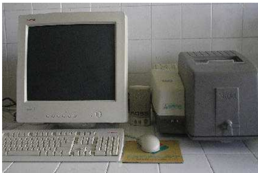
Figura 3.8 - Equipamento Avatar - 380 FT-IR. Fonte: Direta, (2006).
