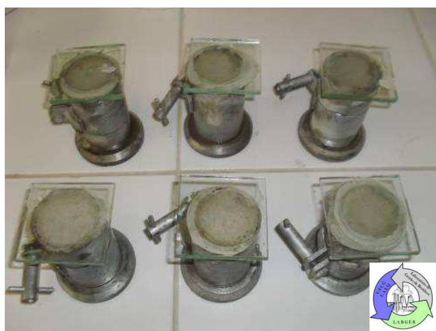
FIGURA 2 – Moldagem dos corpos de prova.
