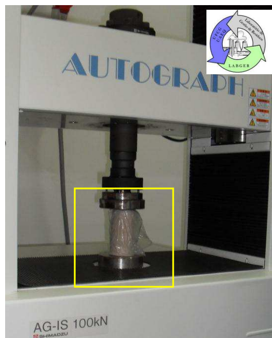
FIGURA 4 – Máquina AUTOGRAPH para o ensaio de Resistência à Compressão.
