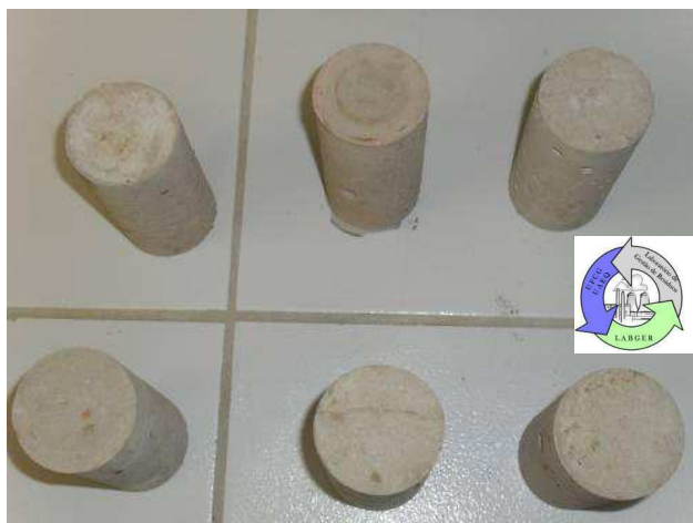
FIGURA 3 – Corpos de prova após a estabilização por solidificação.
