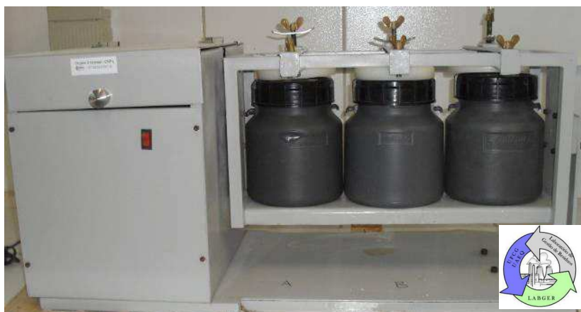
FIGURA 5 – Vista frontal do aparelho rotativo de frascos para lixiviação.
