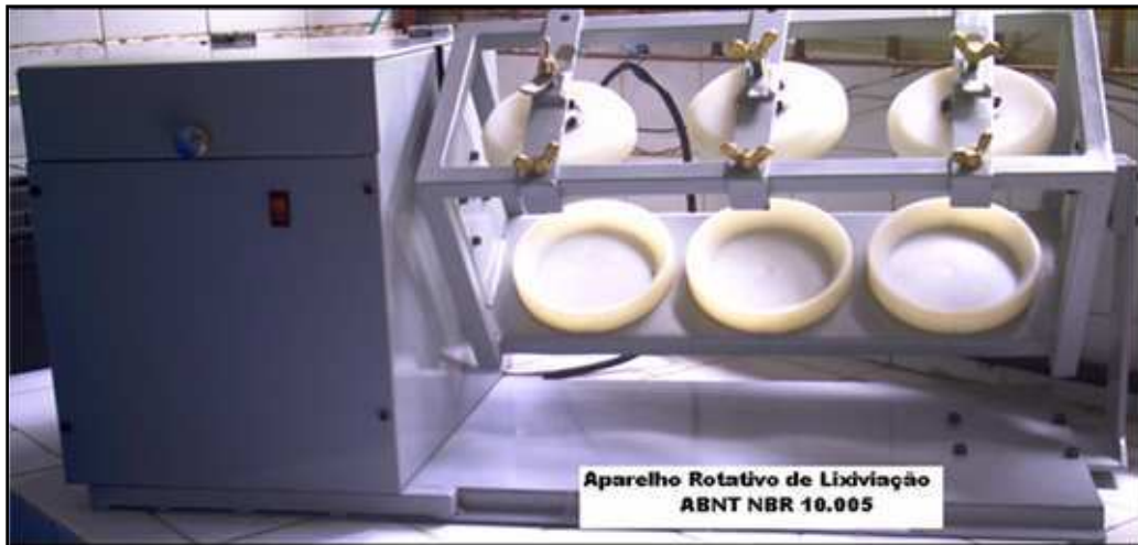
Figura 8 – Vista Frontal do Aparelho Rotativo de Frascos para Lixiviação
