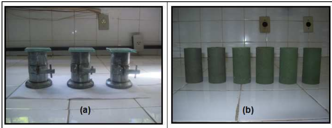
Figura 7 - Molde cilíndrico utilizado e corpos-de-prova preparados
