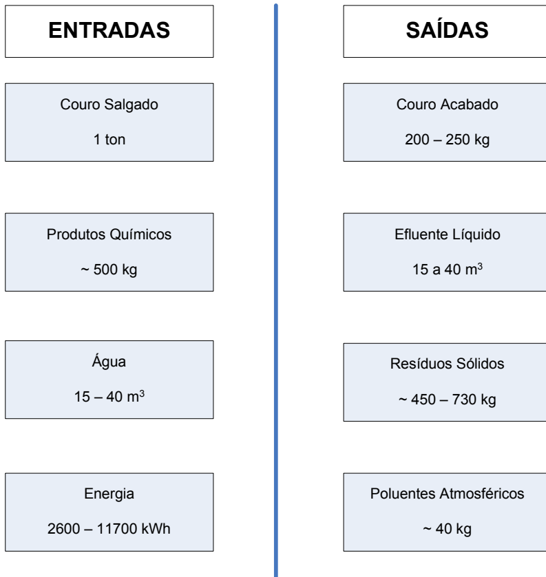
Figura 4 - Fluxos básicos principais de um curtume
