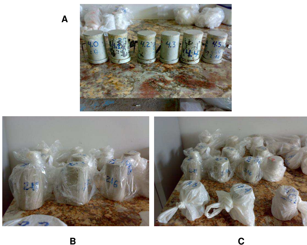
Figura 3.2 – A moldagem das argamassas. B e C acondicionamento dos corpos de prova para cura por período de 07 e 28 dias.
