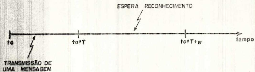
FIG. 2.9 - Diagrama de Tempo no Sistema ARQ-ACK
