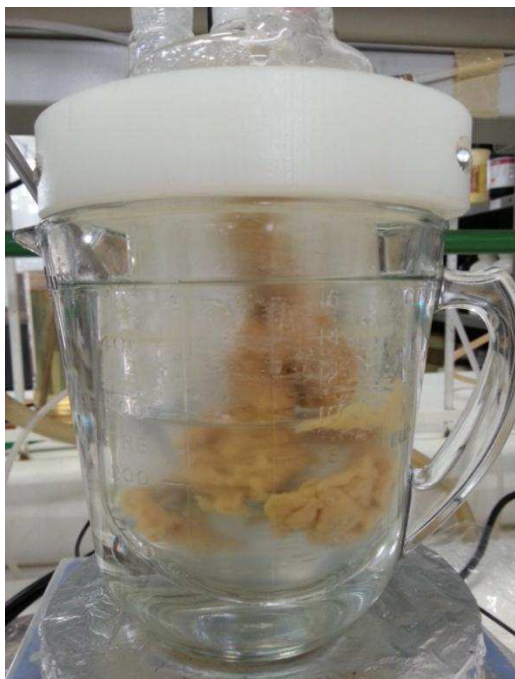
FIGURA 4.1 Material obtido na polimerização in situ ao adicionar argila Brasgel organofílica utilizando solução de 1 g/L de PVA B-24.
