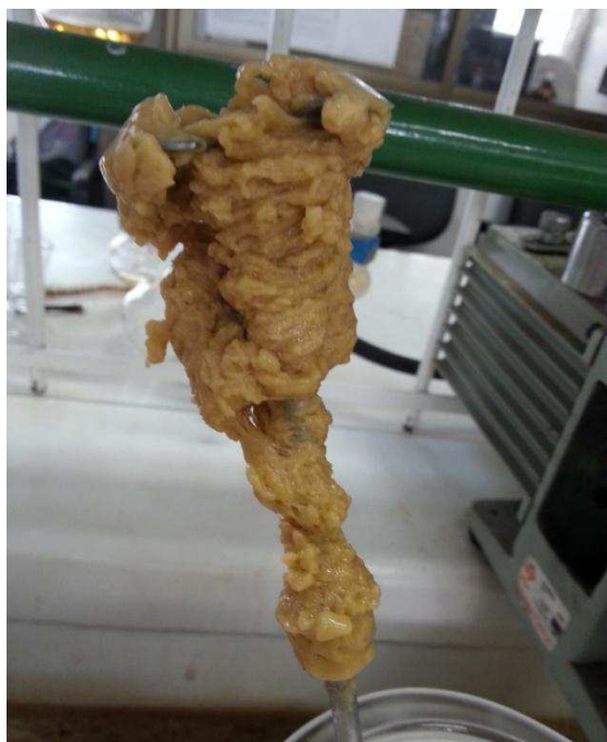
FIGURA 4.2 Material obtido nos testes preliminares da polimerização in situ ao adicionar argila Brasgel organofílica utilizando solução de 2 \text{ g/L} de PVA B-24.
