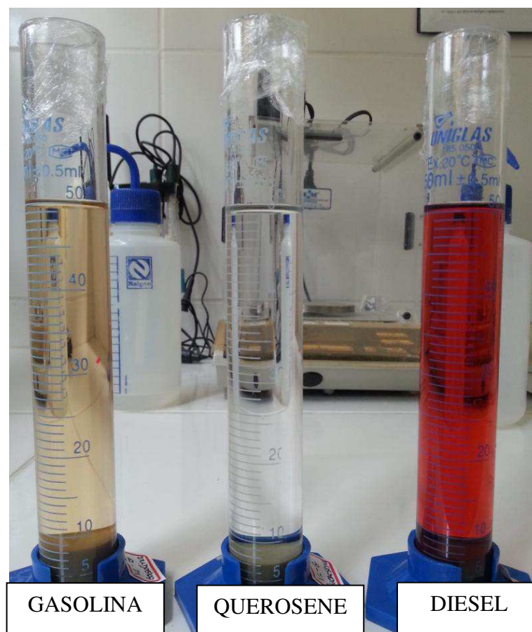
FIGURA 3.2 Ilustração do teste de Inchamento de Foster.
