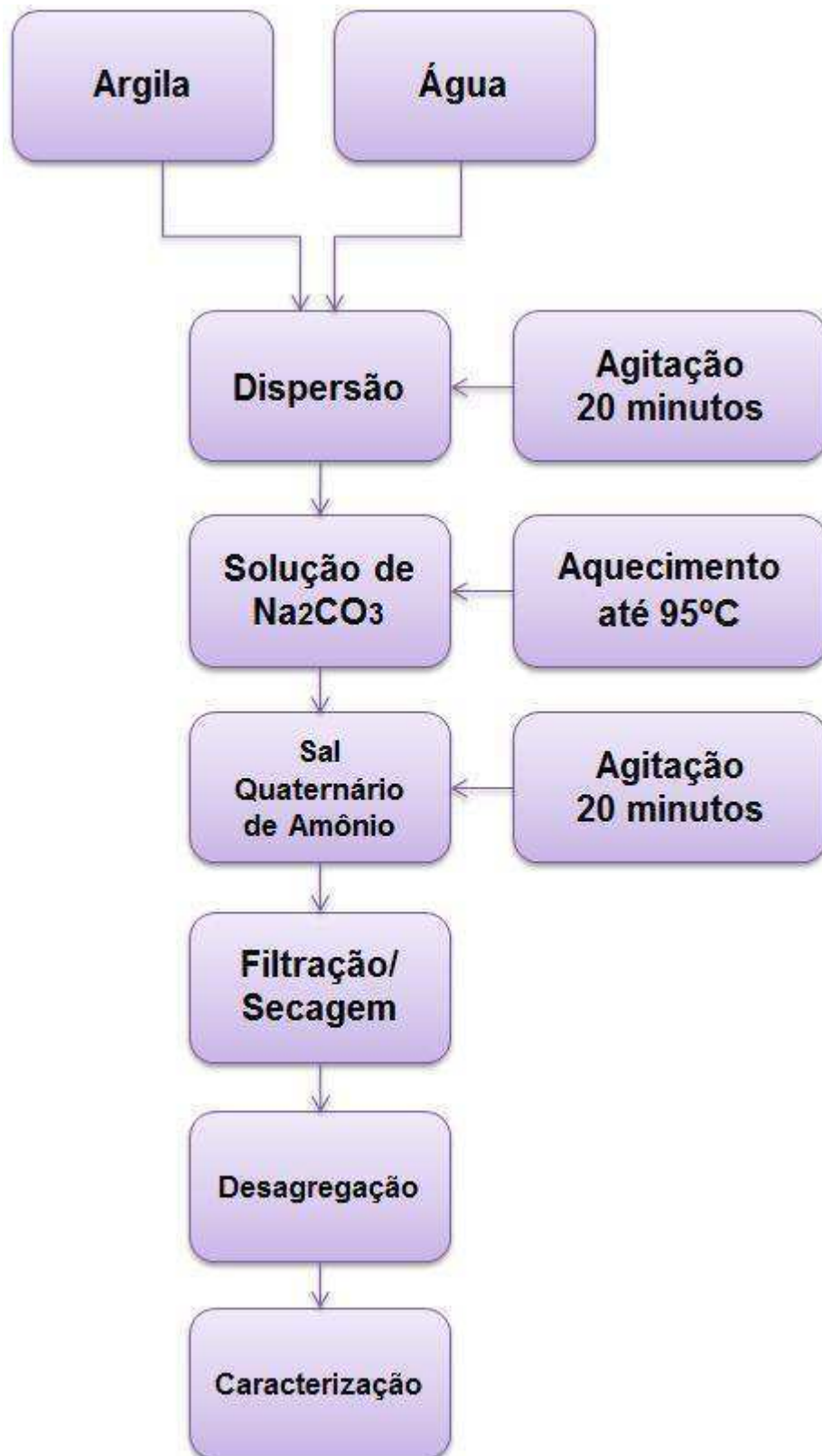
FIGURA 3.0 Esquema das etapas de preparação das argilas organofílicas.
