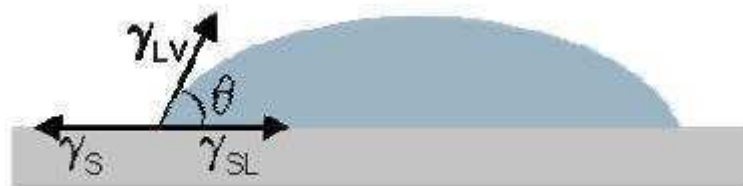
Figura 2.9. Diagrama esquemático da medição do ângulo de contato. Fonte: (SOUZA et al, 2006)
