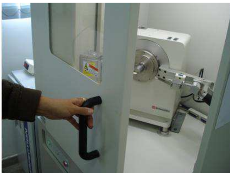
Figura 29: Equipamento utilizado para análise de DRX (SHIMADZU XRD-6000).
