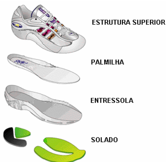
Figura 2 - Componentes do sapato tênis (Fonte: Adaptado de Calçados esportivos, 2008).
