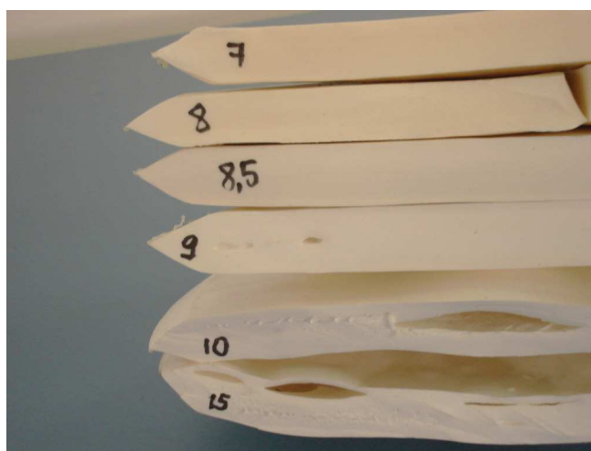
Figura 19- Amostras de Espumas de EVA/EPDM com diferentes tempos de prensagem.
