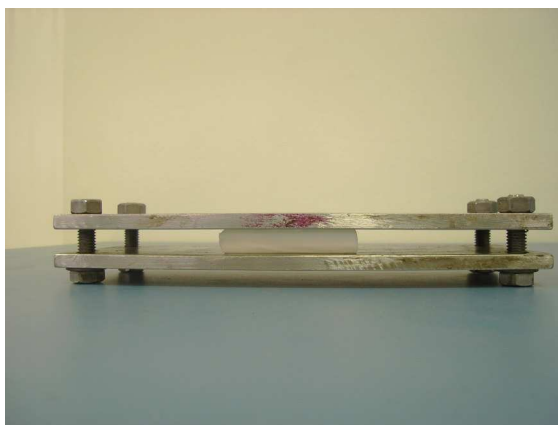
Figura 12- Dispositivo utilizado para os ensaios de deformação permanente à compressão (DPC) das espumas.
