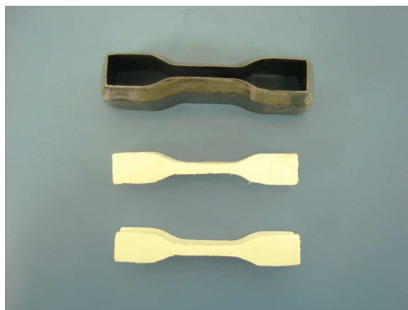
Figura 13- Corpos de prova obtidos a partir dos compostos expansíveis para serem submetidos aos ensaios de tração.
