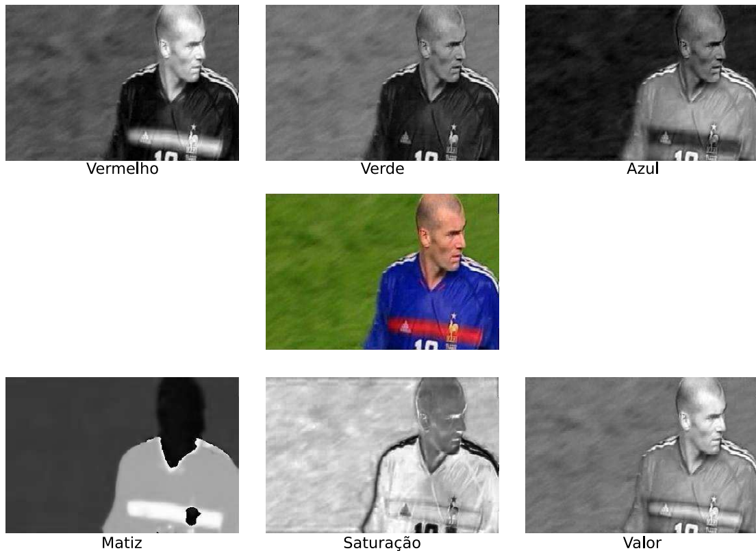
Figura 2.2: Exemplo de imagem (ao centro) decomposta em canais de espaços de cores diferentes (RGB acima e HSV abaixo).
