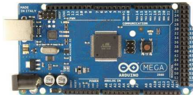
Figura 4.12- Arduino Mega 2560, baseado no microcontrolador ATmega 2560 [25].
