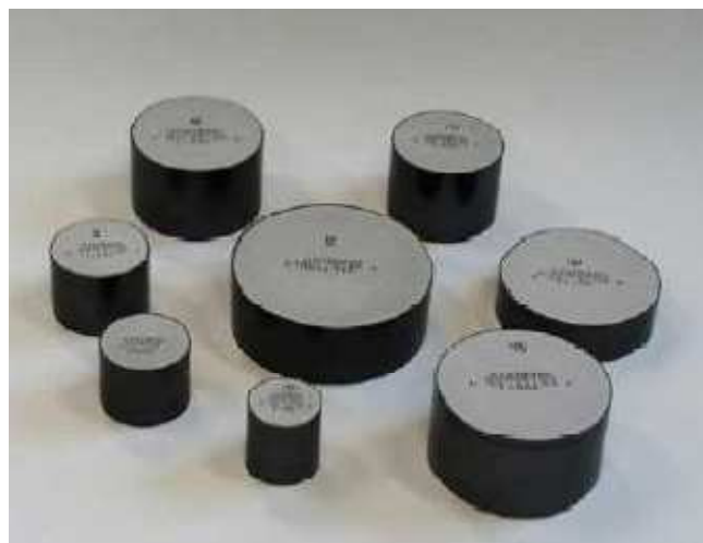
Figura 2.7 - Varistores com diâmetros e alturas diferentes. Fonte: (HINRICHSEN, 2001).
