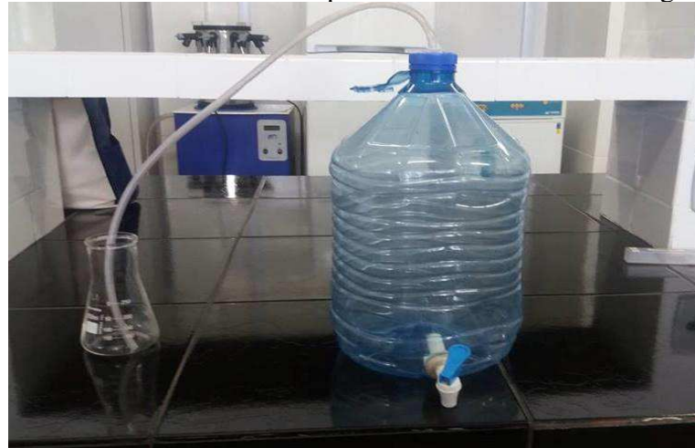
Figura 3 – Reator utilizado no processo fermentativo sem agitação.
