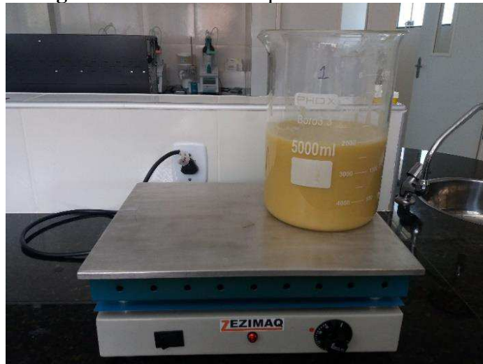
Figura 2 – Processo de aquecimento do mosto.
