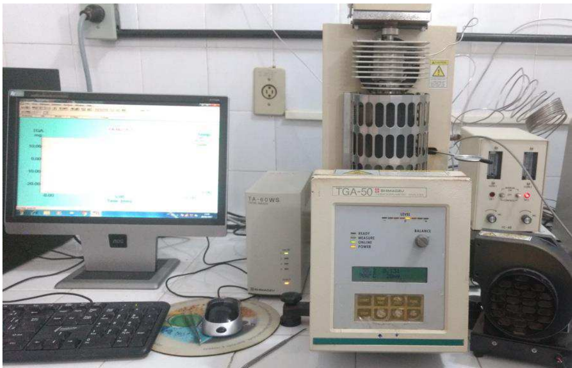
Figura 13 - Shimadzu termobalança, modelo TGA-50, acoplada ao sistema de ventilação e ao computador
