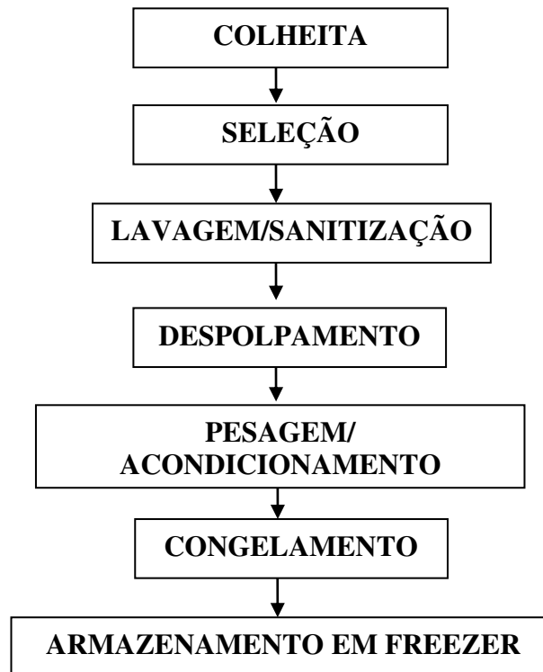
Figura 3.2 - Fluxograma do processamento para obtenção da polpa de cumbeba
