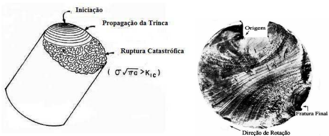
Figura 20 - Aspecto macroscópico de uma ruptura por fadiga, indicando o ponto de início da trinca, sua propagação e ruptura fina sob carregamento de tração e torção, respectivamente.
