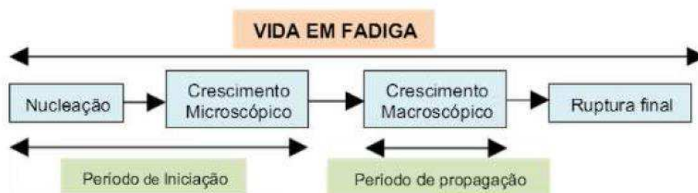
Figura 19 - Processo de fadiga tipicamente observado nos materiais metálicos em geral.
