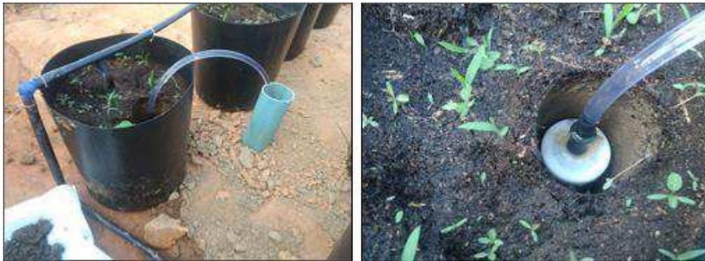
**Figura 15.** Cápsula de cerâmica e pressostato na parcela controle.
