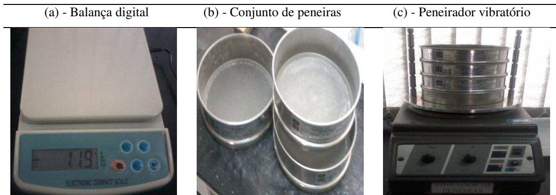
Figura 24 – Equipamentos utilizados para a distribuição granulométrica do minério
