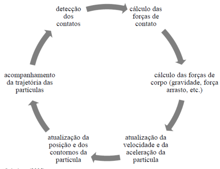
Figura 15 - Ciclo de cálculo do método dos elementos discretos
