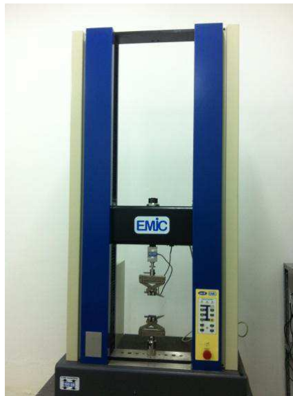
Figura 3.38: Máquina de Tração EMIC 100 kN, onde foram realizados os ensaios de tração.
