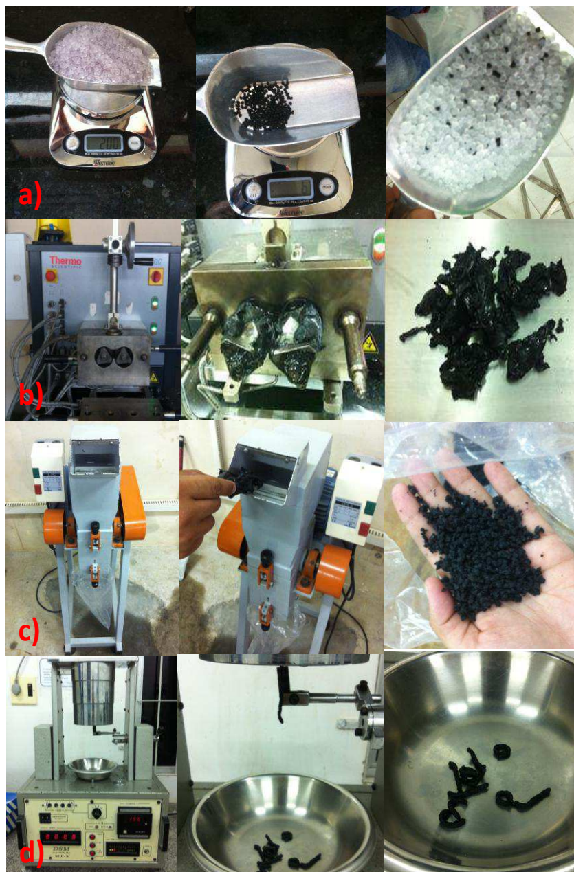
Figura 3.29: Etapas para a realização dos ensaios de FMI – a) pesagem dos compostos; b) homogeneização da mistura; c) moagem e preparação das amostras; d) Ensaio de MFI.
