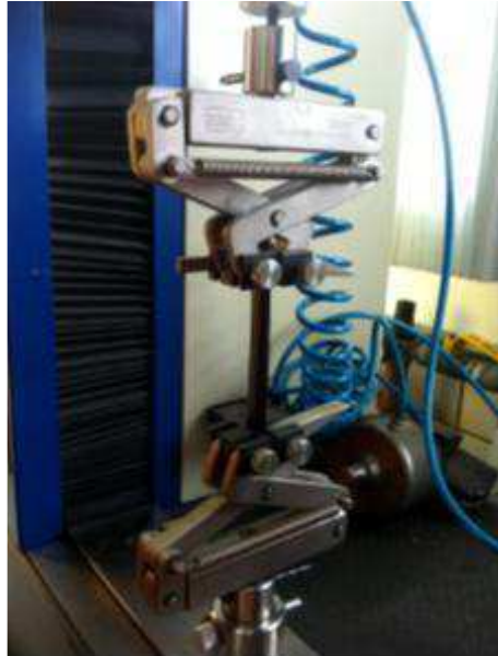
Figura 3.35: Início do ensaio de tração.
