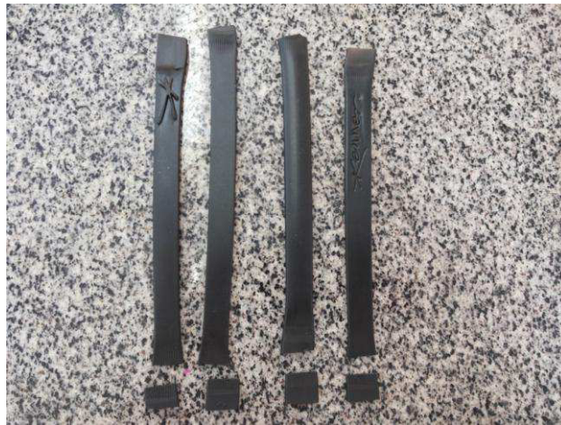
Figura 3.37: Ruptura após o ensaio de tração.
