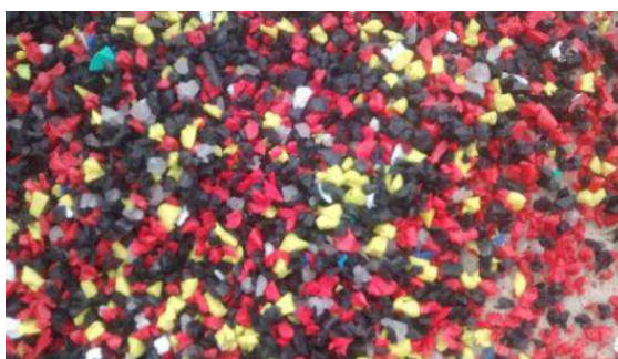
Figura 3.6: Material triturado - galhos, cabedais reprovados e materiais expurgados.
