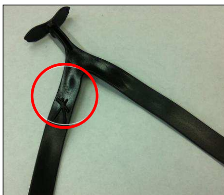
Figura 4.21: Cabedal com excesso de brilho.
