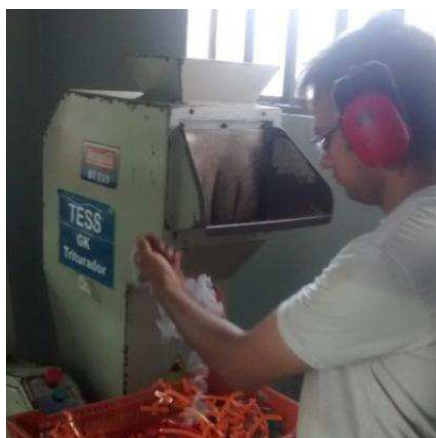
Figura 3.9: Moinho GK MF 230, 3 lâminas capacidade de processamento de 80 m 3 /h.
