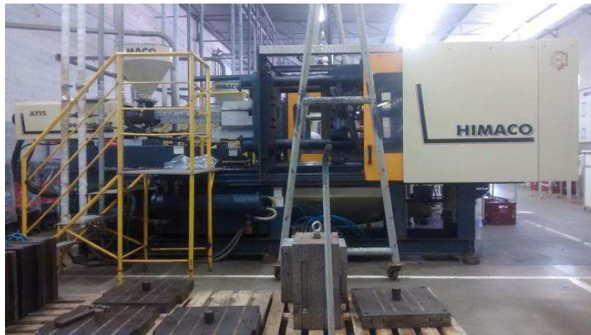
Figura 3.10: Máquina HIMACO ATIS 2000–740, utilizada nos experimentos.
