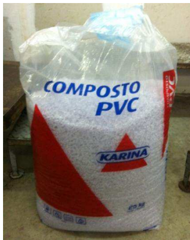
Figura 3.4: Composto de PVC cristal dureza 65 – Embalagem de 25 kg.
