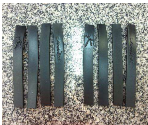
Figura 3.34: Corpos de prova obtidos de cabedais injetados.
