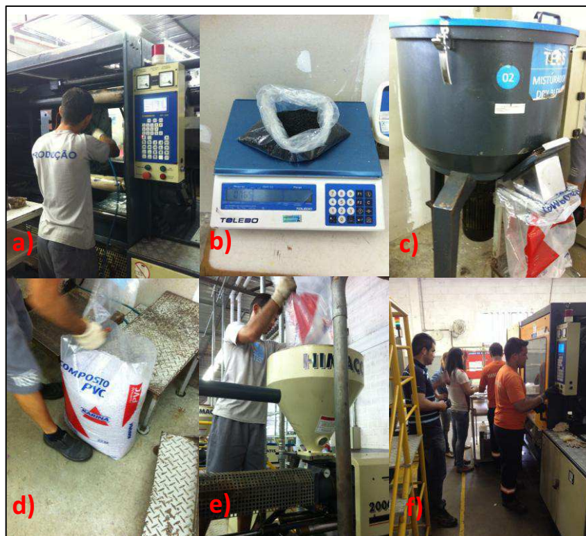
Figura 3.24: 1ª etapa de injeções de amostras – a) ajustagem de matriz na máquina; b) pesagem da massa de pigmento; c) homogeneização da mistura (pigmento + PVC cristal); d) obtenção da mistura homogeneizada; e) alimentação do conjunto plastificador da ATIS 2000-740; f) parametrização da máquina.
