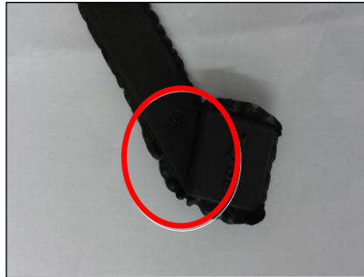
Figura 4.16: Cabedal com rebarba.
