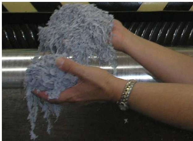
Figura 2.7 - Aparas de couro curtido ao cromo (III) originado da máquina de rebaixar. Fonte: Direta, 2007.
