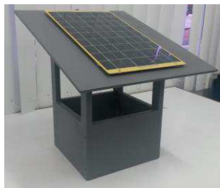
Figura 3.8 – Sistema de exaustão para secador solar de frutas.
