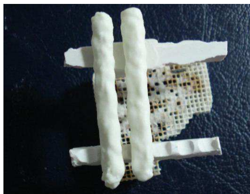
Figura 10. Barras de alumina com as superfícies recobertas pelo vidro
