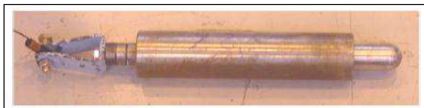
Figura 7 - Impactador utilizado nos ensaios.
