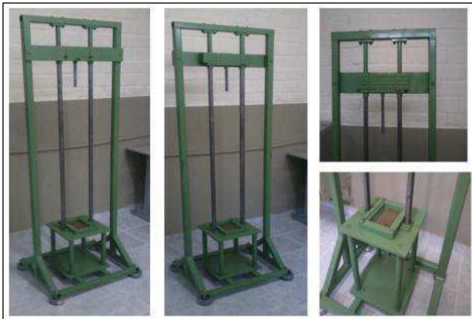
Figura 4.65 - Máquina de impacto por queda de peso para materiais compósitos.
