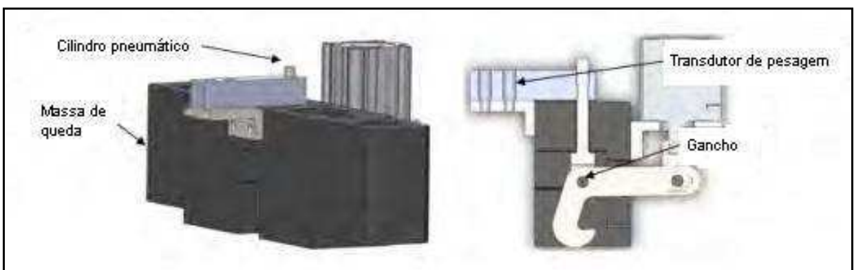
Figura 4.14 - Mecanismo de trava e liberação do impactador
