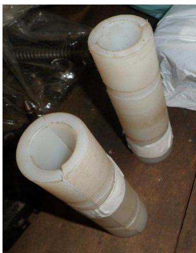
Figura 4.83 - Batentes em nylon do sistema anti rebote.
