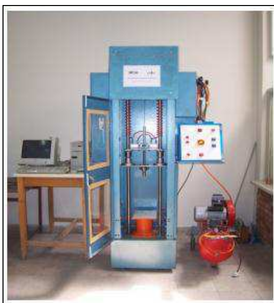
Figura 9 - Máquina de impacto por queda de peso projetado e fabricado na pesquisa.
