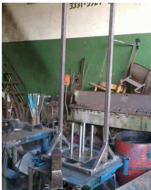
Figura 4.62 - Estrutura da máquina soldada.
