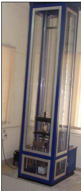
Figura 4.26 - Máquina de impacto por queda de peso desenvolvida.
