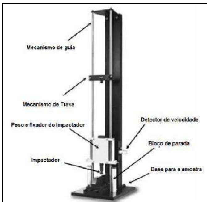
Figura 4.1 - Máquina de impacto por queda de peso para materiais compósitos.
