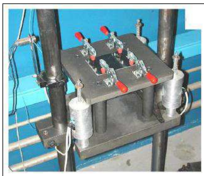
Figura 13 - Base de fixação do corpo de prova.
