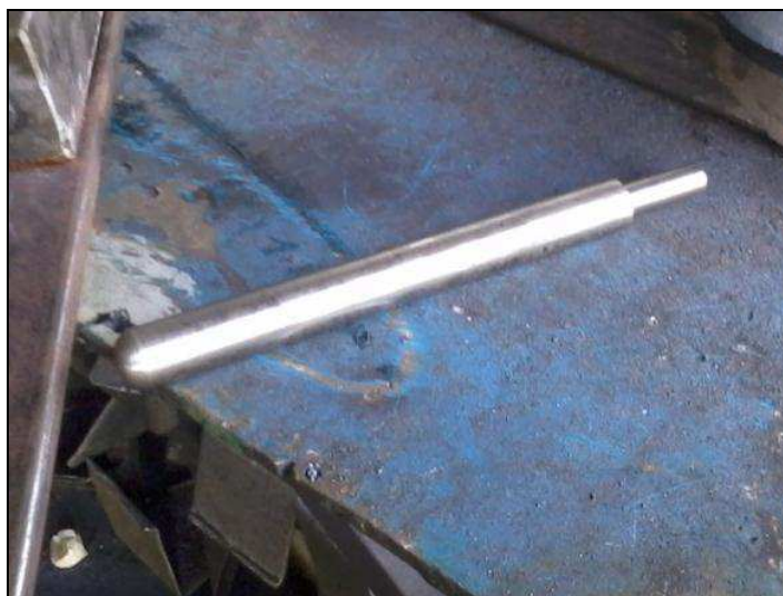
Figura 4.60 - Impactador de ponta semiesférica em aço SAE 4340.
