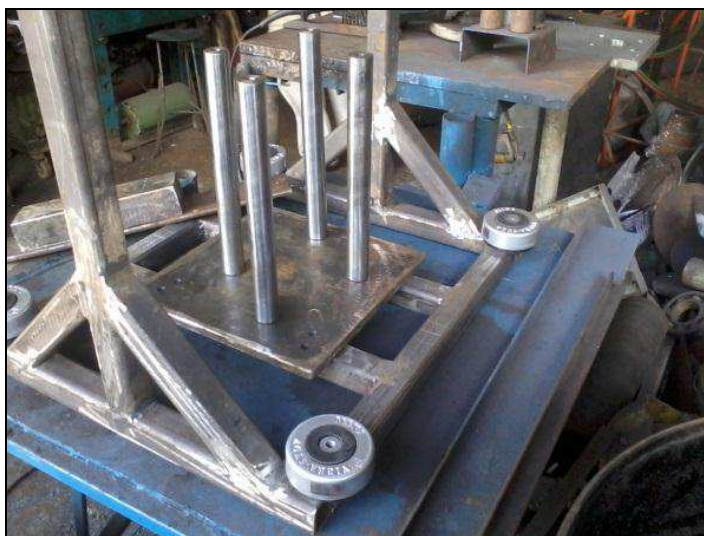
Figura 4.59 - Estrutura da máquina soldada, base e os amortecedores de vibrações.
