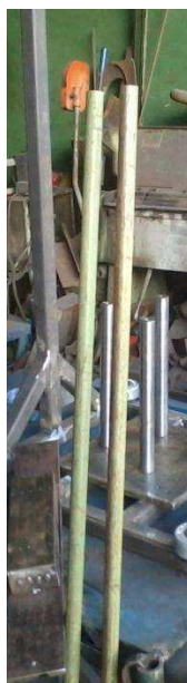
Figura 4.63 - Tubos cilíndricos utilizados como guias de deslizamento dos pesos.
