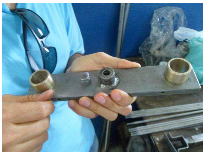
Figura 4.88 - Novas buchas de bronze para o deslizamento dos pesos.
