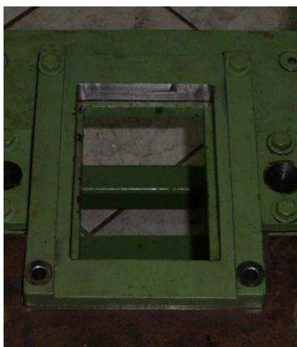
Figura 4.89 - Placa de fixação do corpo de prova após o alargamento da abertura.
