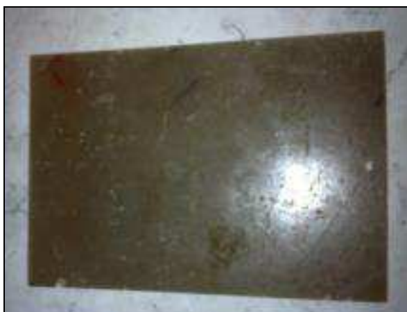
Figura 3.1 - Corpo de prova para ensaio de impacto por queda de peso.
