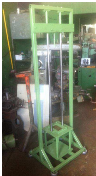
Figura 4.64 - Máquina de impacto por queda de peso para materiais compósitos desenvolvida.
