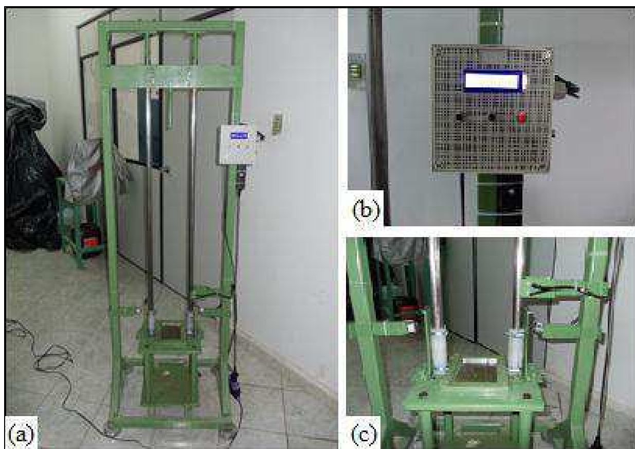
Figura 4.85 - (a) Máquina de impacto montada (b) Detalhe da caixa com o sistema de aquisição de dados (c) Detalhe do sistema anti rebote automatizado.
