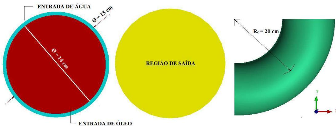
Figura 3. 2 - Detalhe das regiões de entrada de água e óleo, região de saída e curvatura do duto.
