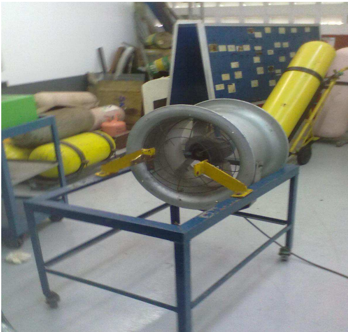
Figura 27. Sistema de ventilação forçada.
