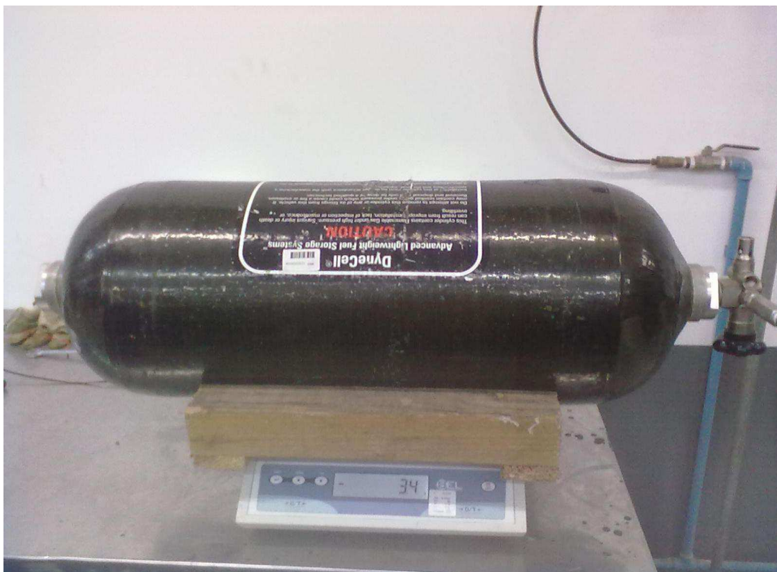
Figura 25. Cilindro de gás natural veicular em material compósito e alumínio.
