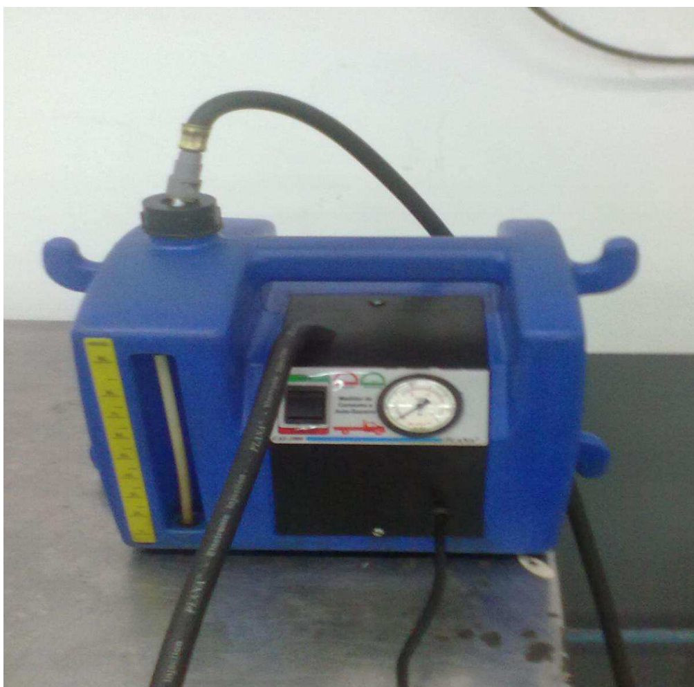
Figura 24. Tanque e bomba externa de combustível.
