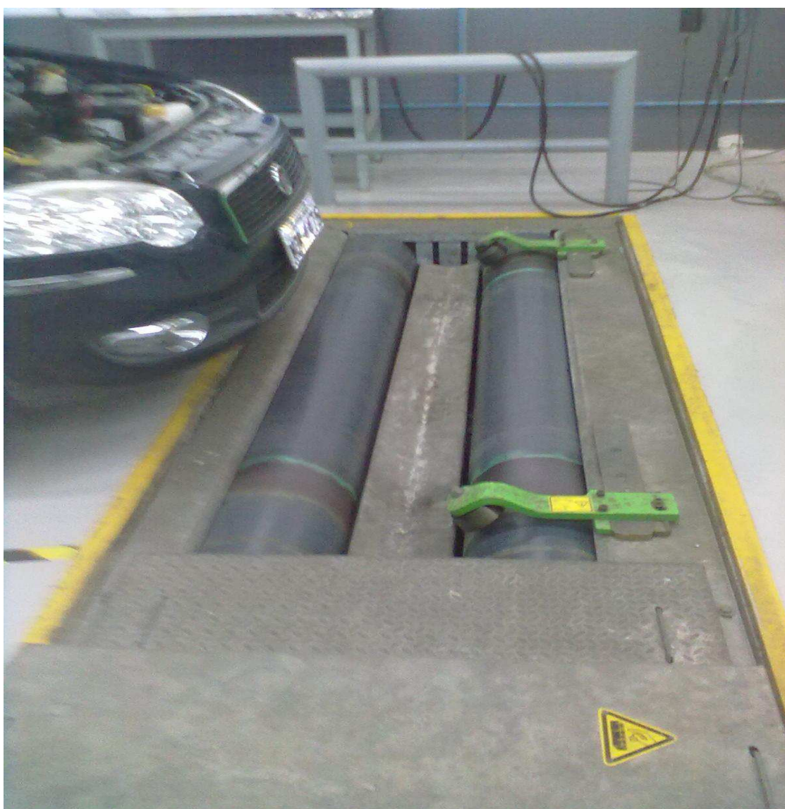
Figura 22. Dinamômetro de chassi modelo FLA 203 do fabricante BOSCH, no CTGAS-ER.
