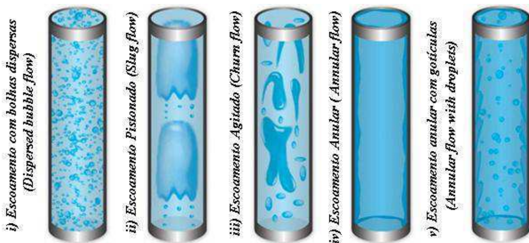
Figura 2.4: Tipos de escoamento bifásicos em dutos verticais
