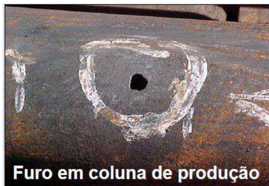
Figura 2.12: Furo na coluna de produção Fonte: Henriques, 2008
