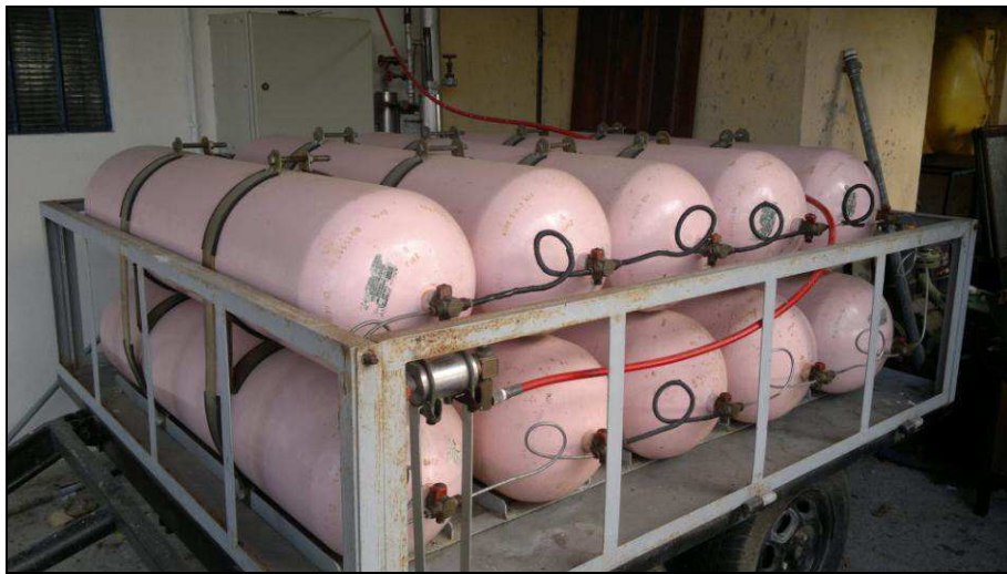
Figura 3.19 – Sistema de armazenagem de gás natural
