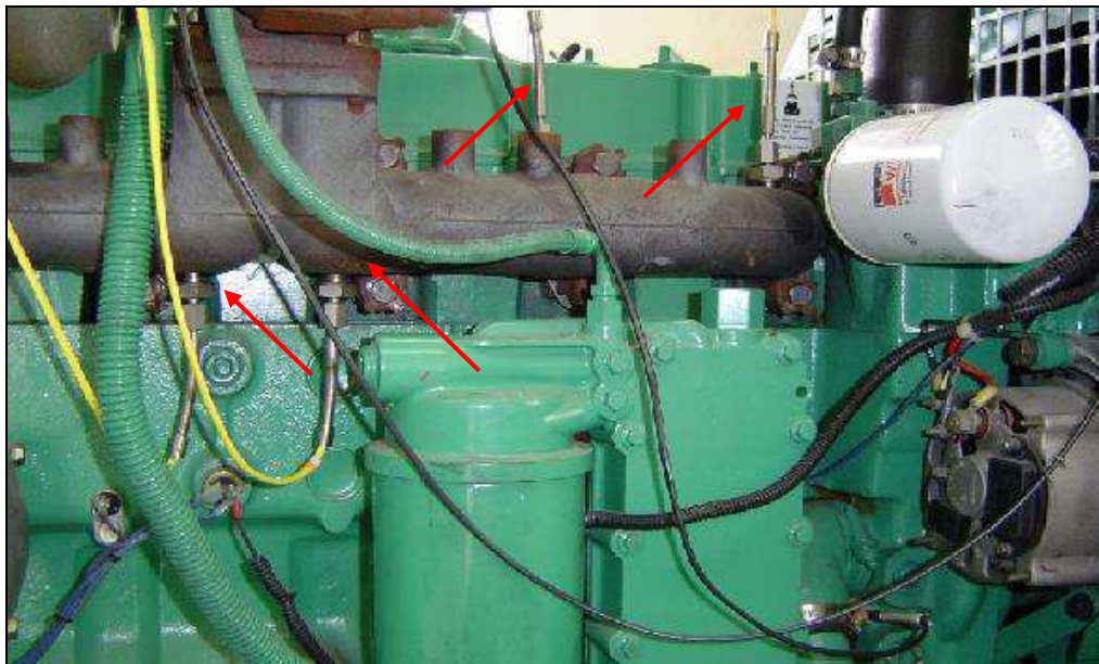
Figura 3.6 – Termopares instalados no coletor de escapamento
