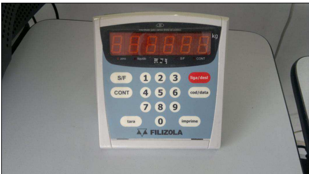
Figura 3.5b – Sistema de controle de pesagem do combustível diesel/biodiesel
