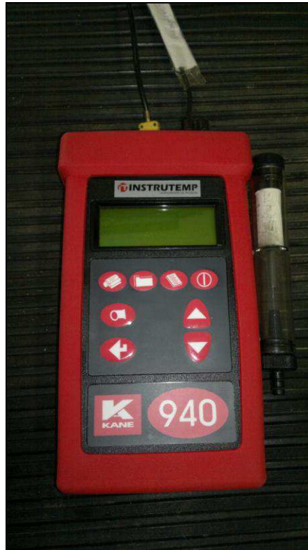
Figura 3.15 – Analisador de gases/modelo K 940
