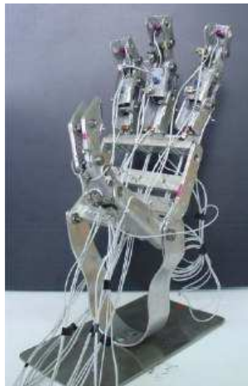
Figura 7. Protótipo de mão desenvolvida com atuadores de LMF (Fárias et al, 2009).
