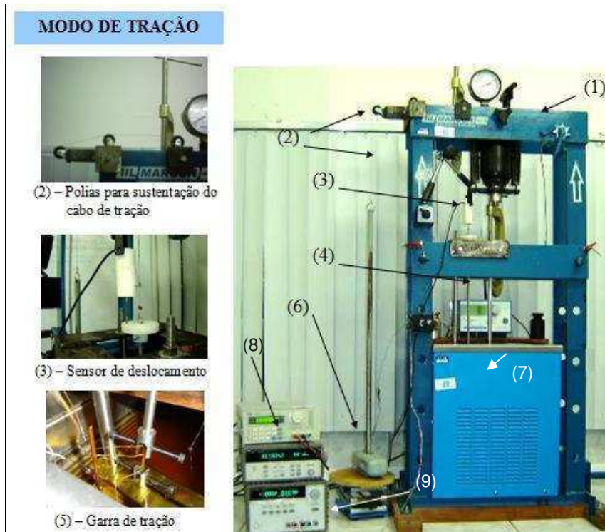
Figura 26. Fotografia da BCT desenvolvida por Nascimento Neto (2007). (1) Estrutura rígida. (2) Cabo de tração. (3) Sensor de deslocamento LVDT. (4) Haste móvel. (5) Garra de tração. (6) Carga de tração. (7) Banho termoregulável. (8) Fonte de tensão e corrente. (9) Sistema de aquisição de dados.
