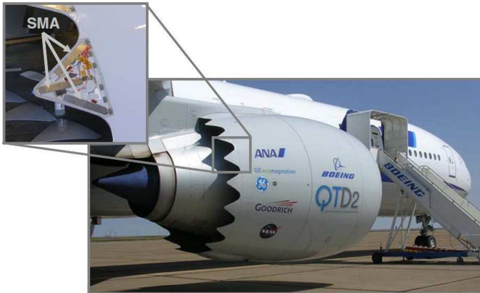
Figura 5. Aplicação de barras de LMF (em inglês Shape Memory Alloys – SMA ) em um avião de testes da Boeing (Mabe et al, 2006 apud Lagoudas, 2008).
