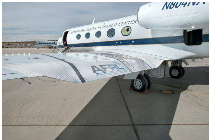
Figura 9. Flap com bordo de fuga variável instalado em uma aeronave GIII defletido em 20^\circ .
