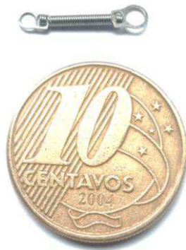
Figura 25. Micro mola de LMF NiTi empregada como atuador no protótipo desenvolvido.
