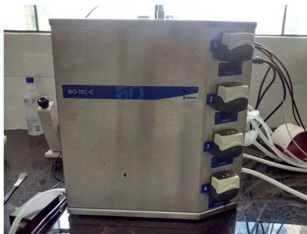
Figura 8. Módulo de controle Controlador, responsável pela agitação do mosto no biorreator e controle das variáveis do processo, o mesmo excuta as funções definidas pelo operador no computador que está interligado ao aparelho. (Fonte: Analu Freitas).
