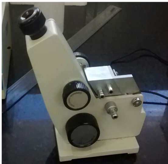
Figura 3. Refratômetro utilizado para determinar o grau brix do meio de cultura e do mosto no experimento.
