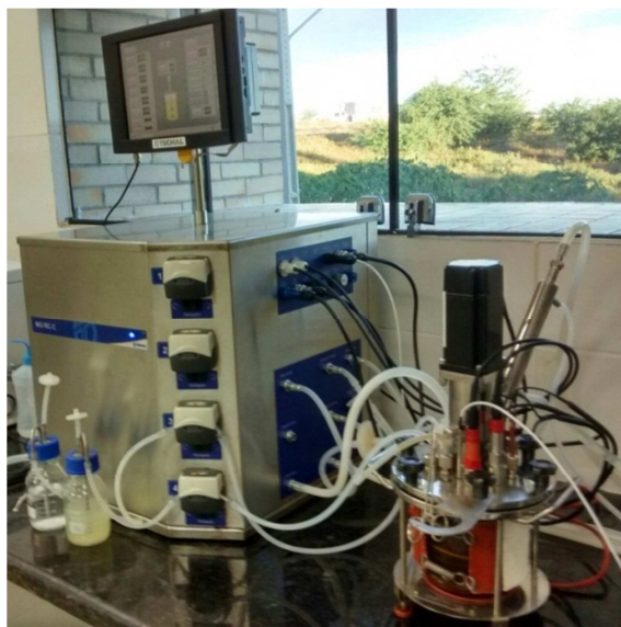
Figura 7. Aparelho biorreator completo utilizado no experimento do Centro de Desenvolvimento sustentável do Semiárido CDSA/UFCG (Fonte: Analu Freitas)
