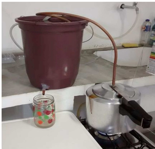
Figura 14. Alambique artesanal utilizado para destilação do caldo fermentado. (Fonte: Analu Freitas)
