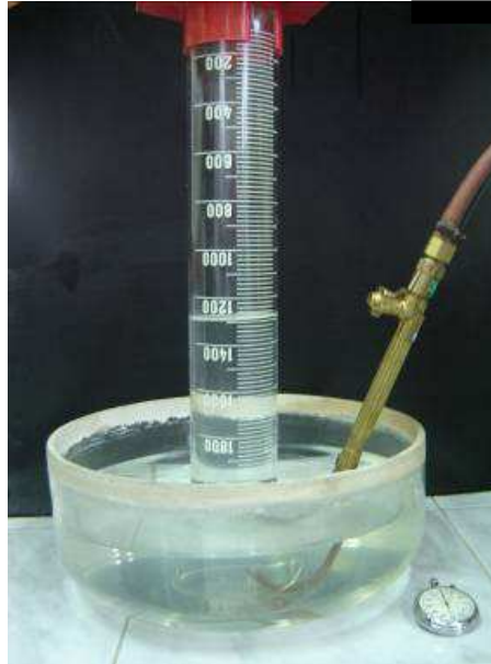
Foto 3.2: Sistema experimental utilizado para determinar o fluxo de gás.
