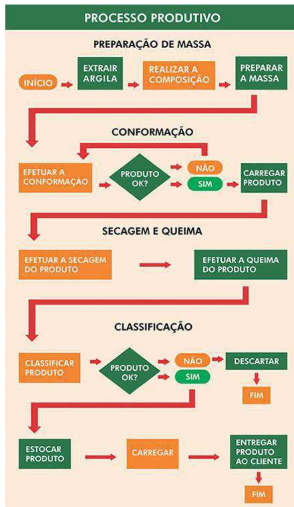
Figura 2.5- Fluxograma do processo de fabricação de tijolos. Fonte: http://ceramicprimavera.net/processo-produtivo.html
