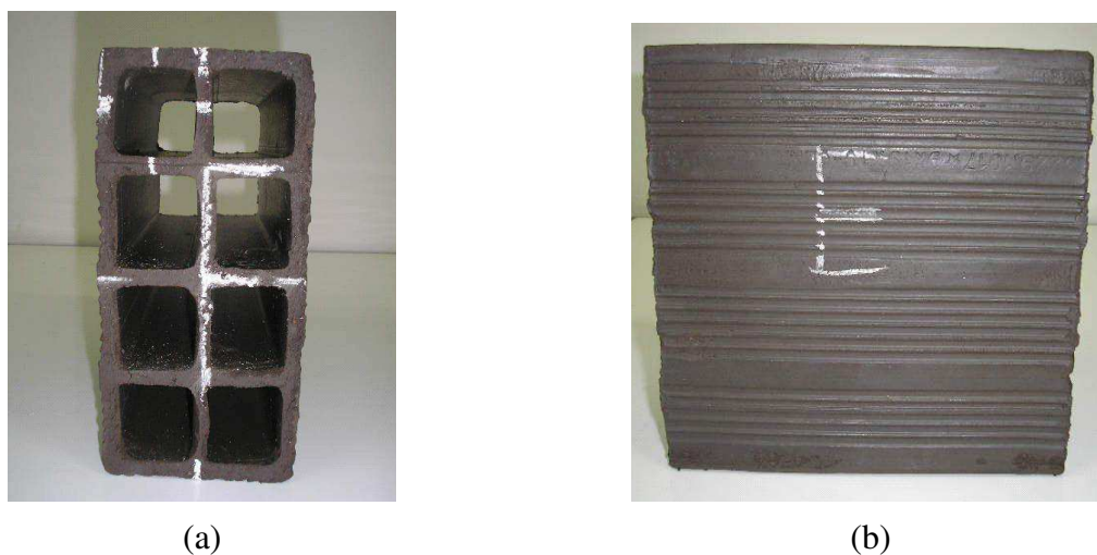
Figura 4.29 - Vista da amostra antes de ser submetida a secagem ( t = 0 ) à temperatura constante de 80^{\circ}\text{C} na estufa. a) Frontal, b) Esquerda. Fonte: Silva (2009).
