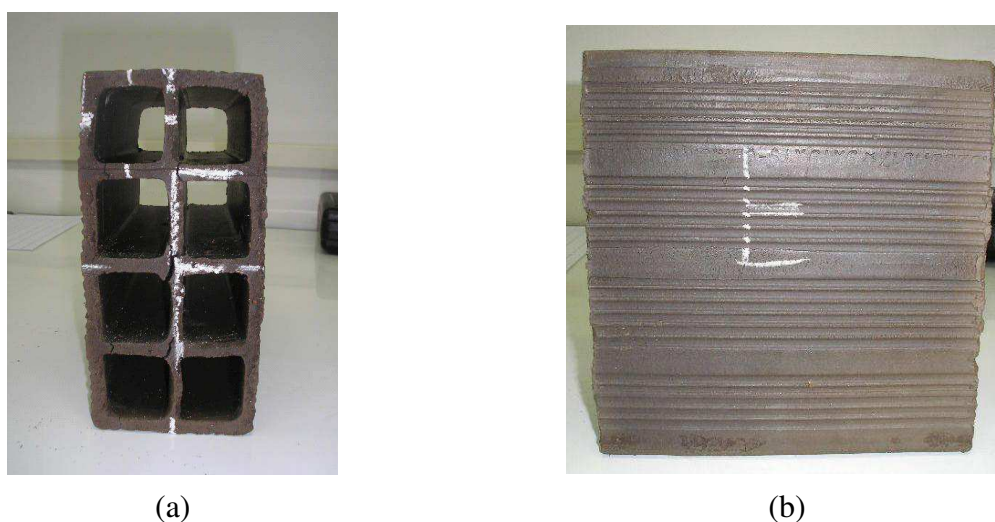
Figura 4.30 – Vista da amostra submetida à secagem ( t = 40 minutos) na temperatura constante de 80^{\circ}\text{C} na estufa ( \theta_{\text{tij}} = 37,1^{\circ}\text{C} , T_{\text{amb.}} = 26,9^{\circ}\text{C} , \text{UR}_{\text{amb.}} = 58\% ). a) Frontal, b) Esquerda. Fonte: Silva (2009).
