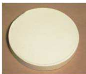
Figura 3.3: Suporte cerâmico ( \alpha -alumina) sinterizado a 1400 °C
