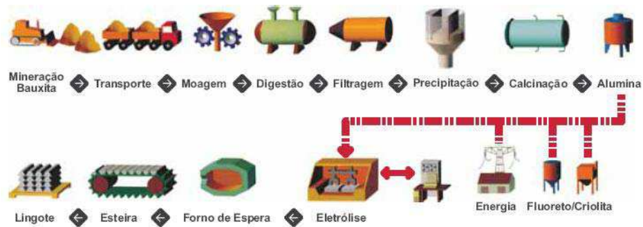
Figura 4 - Fluxograma de produção do alumínio
