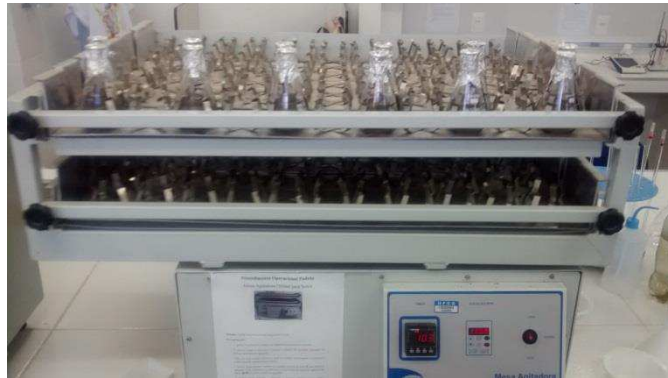
Figura 6 - Frascos Erlenmeyer contendo a mistura água, óleo e biomassa em agitação a 130 rpm e temperatura constante para obtenção das isotermas de equilíbrio.
