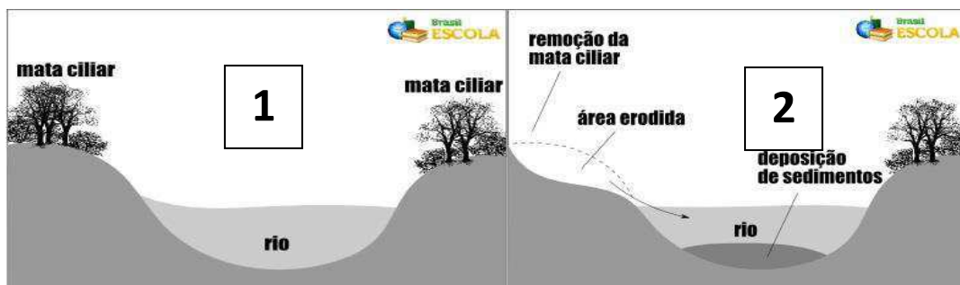
Figura 11 - Esquema do processo de assoreamento.
