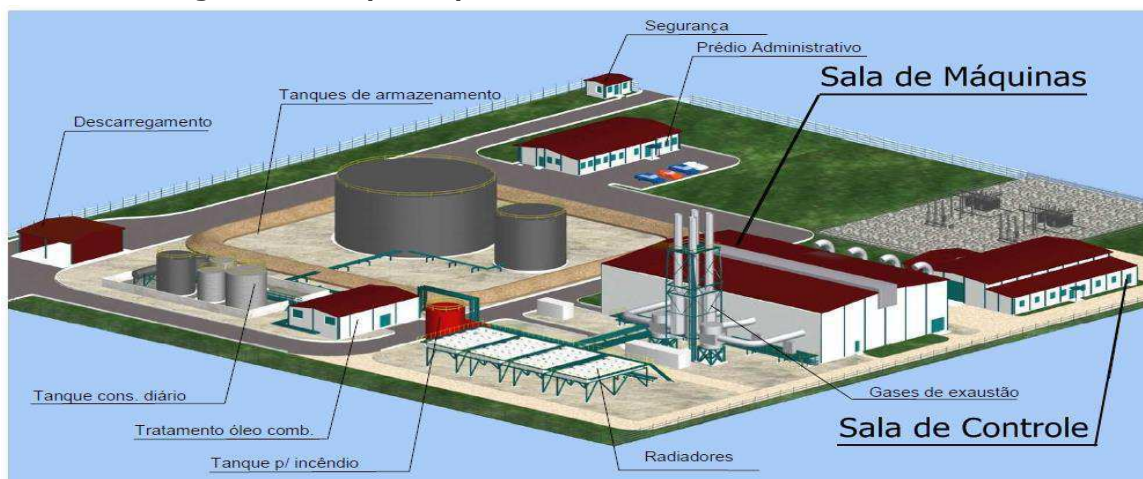
Figura 2. Exemplo de planta de uma usina termoeletrica.
