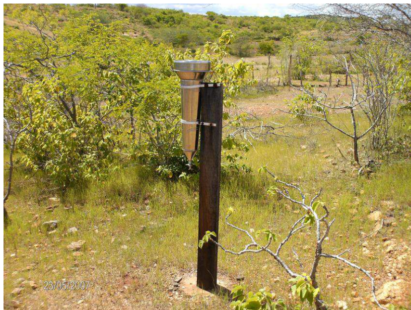
Figura 6 - Pluviômetro Nacional ( Ville de Paris ) instalado na área da microbacia 01
