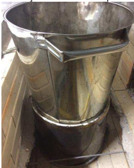
Figura 8 – Reator utilizado na reação de combustão para a obtenção da \text{CoFe}_2\text{O}_4
