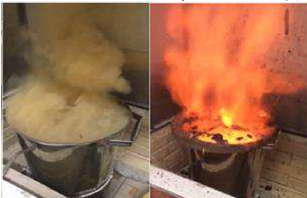
Figura 11 – Gases e chama formada durante a reação de combustão da \text{CoFe}_2\text{O}_4
