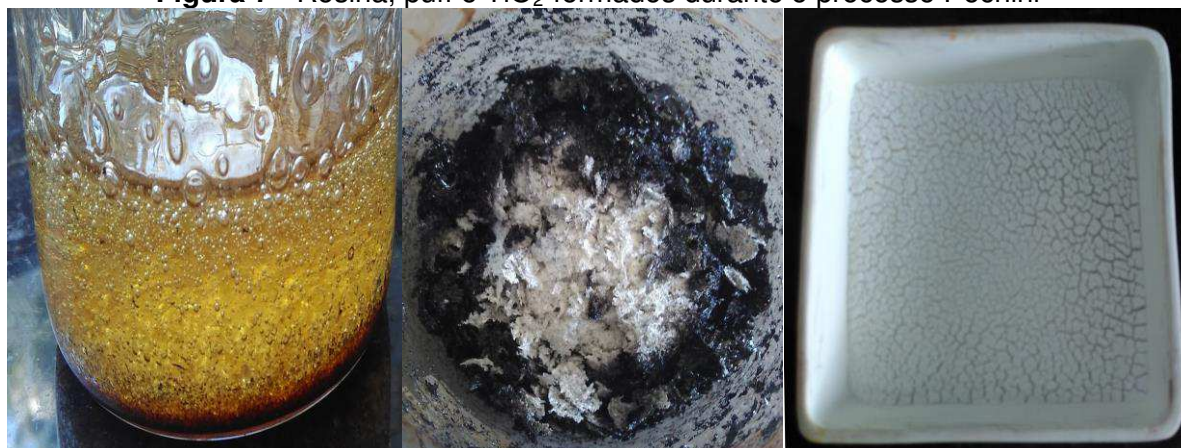
Figura 7 - Resina, puff e TiO 2 formados durante o processo Pechini
