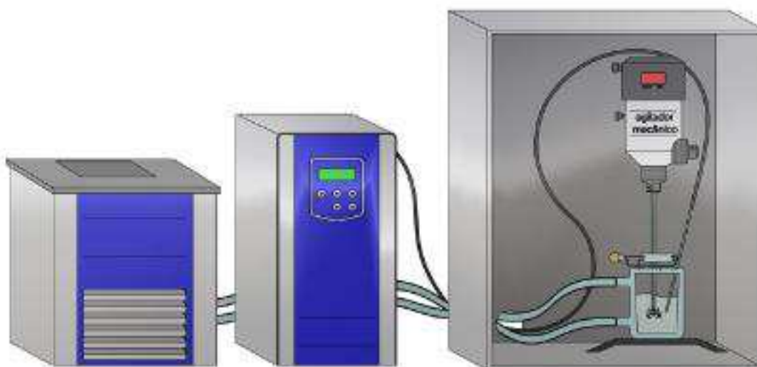
Figura 9 - Sistema reacional utilizando no processo de fotocatalise heterogênea
