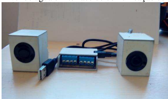
Figura 18: Sensores de nível de água e interface de comunicação com o computador.
