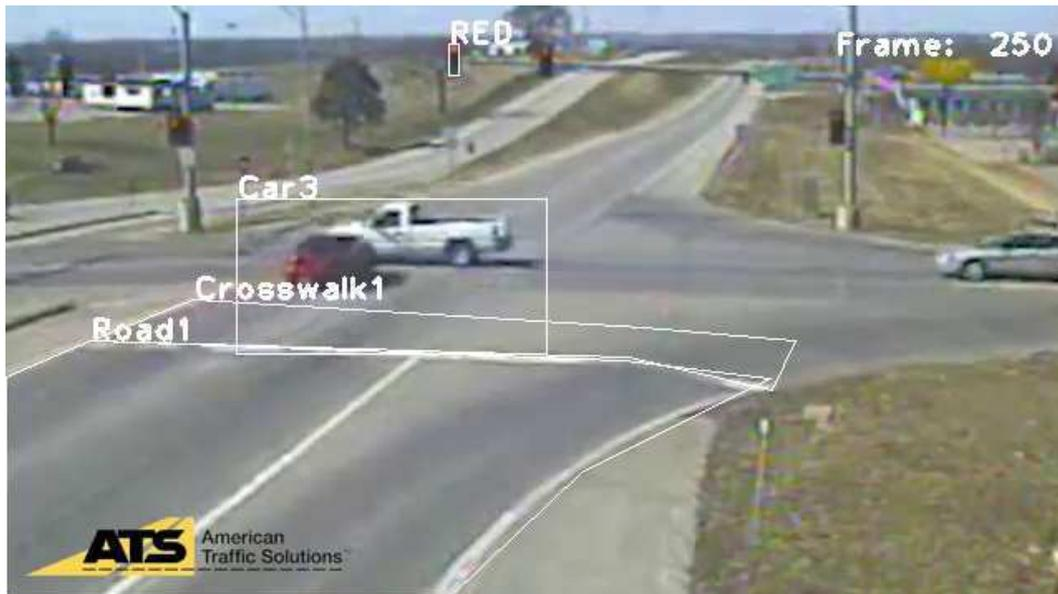
Figura 4.9: Falha no detector de objetos, a detecção “Car3” demarca dois objetos como sendo um único objeto (ATS, 2015).
