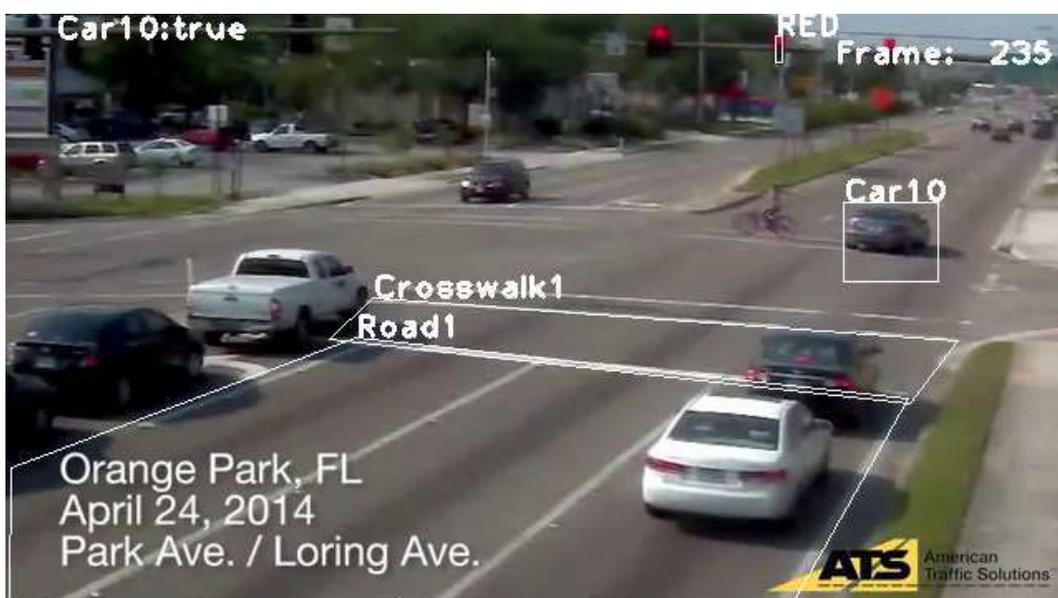
Figura 4.8: Detector de eventos utilizando dados do detector de carros, os polígonos brancos são as detecções, e o texto é o tipo e o identificador numérico do objeto detectado (ATS, 2015).
