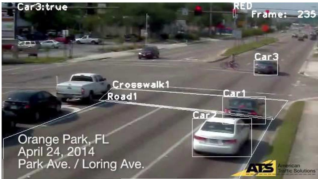
Figura 4.7: Detector de eventos utilizando os rótulos manuais, os polígonos brancos são as detecções e o texto é o tipo e o identificador numérico do objeto detectado (ATS, 2015).
