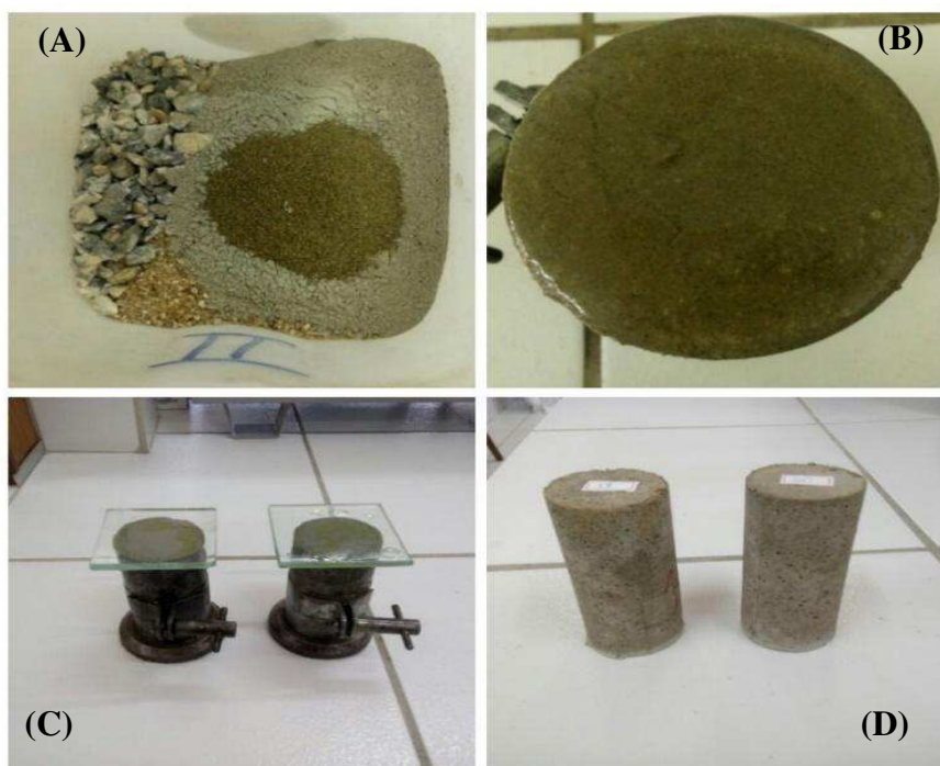
Figura 2: Etapas da preparação dos corpos de prova.
