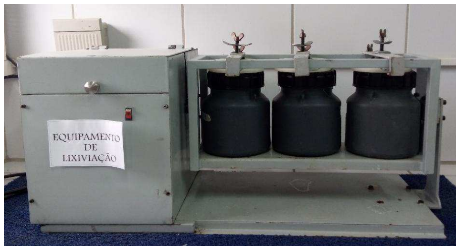
Figura 6: Equipamento rotativo de frascos para o ensaio de lixiviação.
