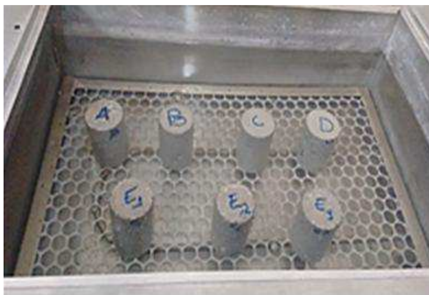
Figura 4: Ensaio de Capacidade de Absorção de Água.
