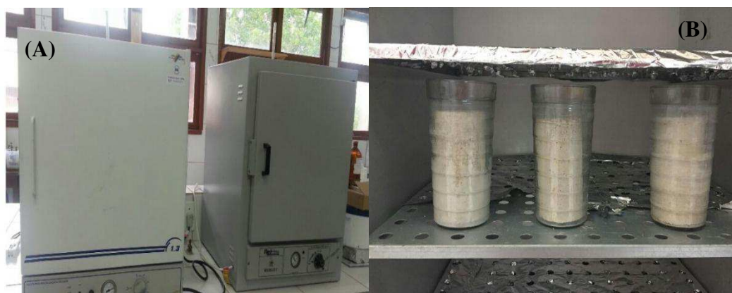
Figura 5: Ensaio de Umidificação/Secagem.
