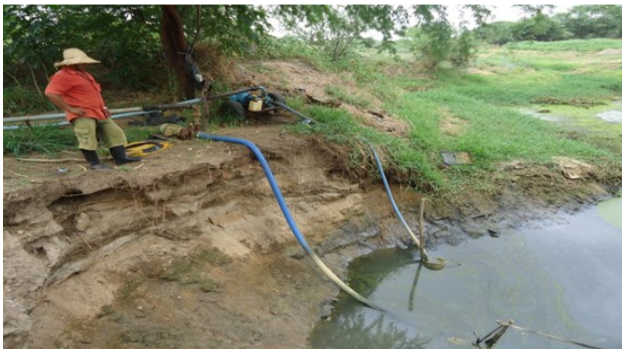
FOTO 03: Captação de água para irrigação em cacimba escavada no leito do rio Sucuru
