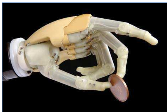
Figura 7 – Prótese ativa comandada por sinais mioelétricos (Farías et al , 2009).
