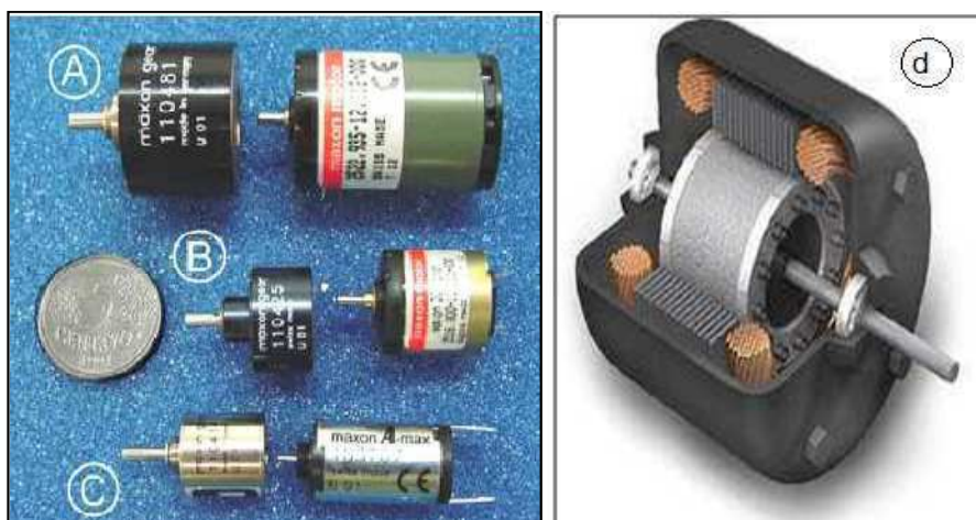
Figura 9 - Micromotores e redutores usados em próteses. a) Motor com torque de 21,45 mN.m e velocidade de 5500 rpm; redutor de 199,3:1; b) Motor com torque de 0,769 mN.m e velocidade de 11693 rpm; redutor de 12:8:1; c) Motor com torque de 1,52 mNm e velocidade de 12300 rpm; redutor de 7:2:1 (Cunha, 2002). d) Estrutura interna do motor CC.
