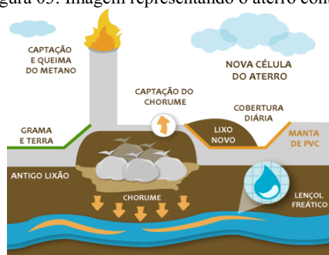
Figura 03: Imagem representando o aterro controlado
