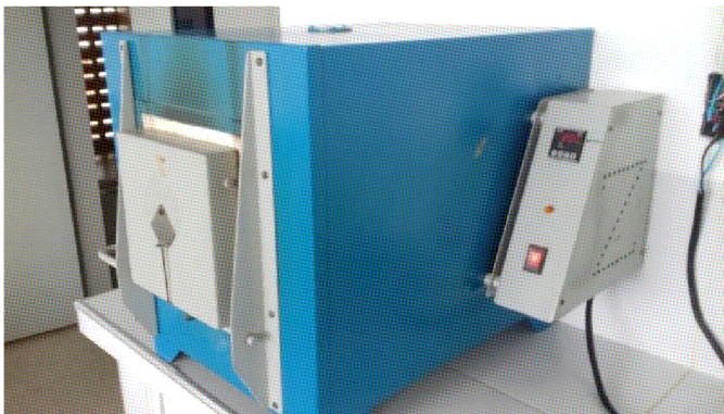
Figura 7: Mufla aquecedora utilizada na experiência.
