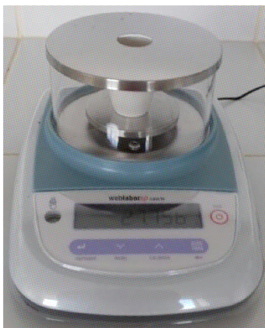
Figura 8: Balança analítica usada para pesagem dos materiais.
