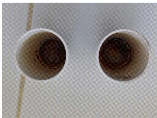
Figura 12: Cadinhos com resíduos da análise térmica utilizando os catalisadores.
