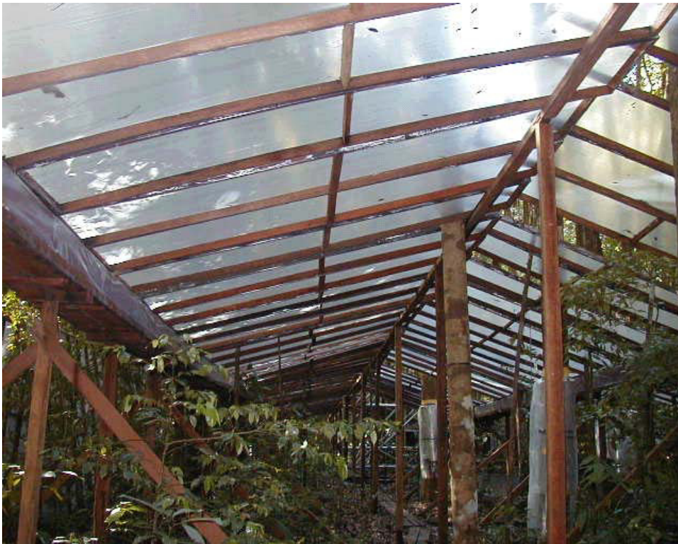
Figura 5. Detalhe das Vistas superior (a) e inferior (b) da cobertura plástica da parcela B no experimento ESECAFLOR
