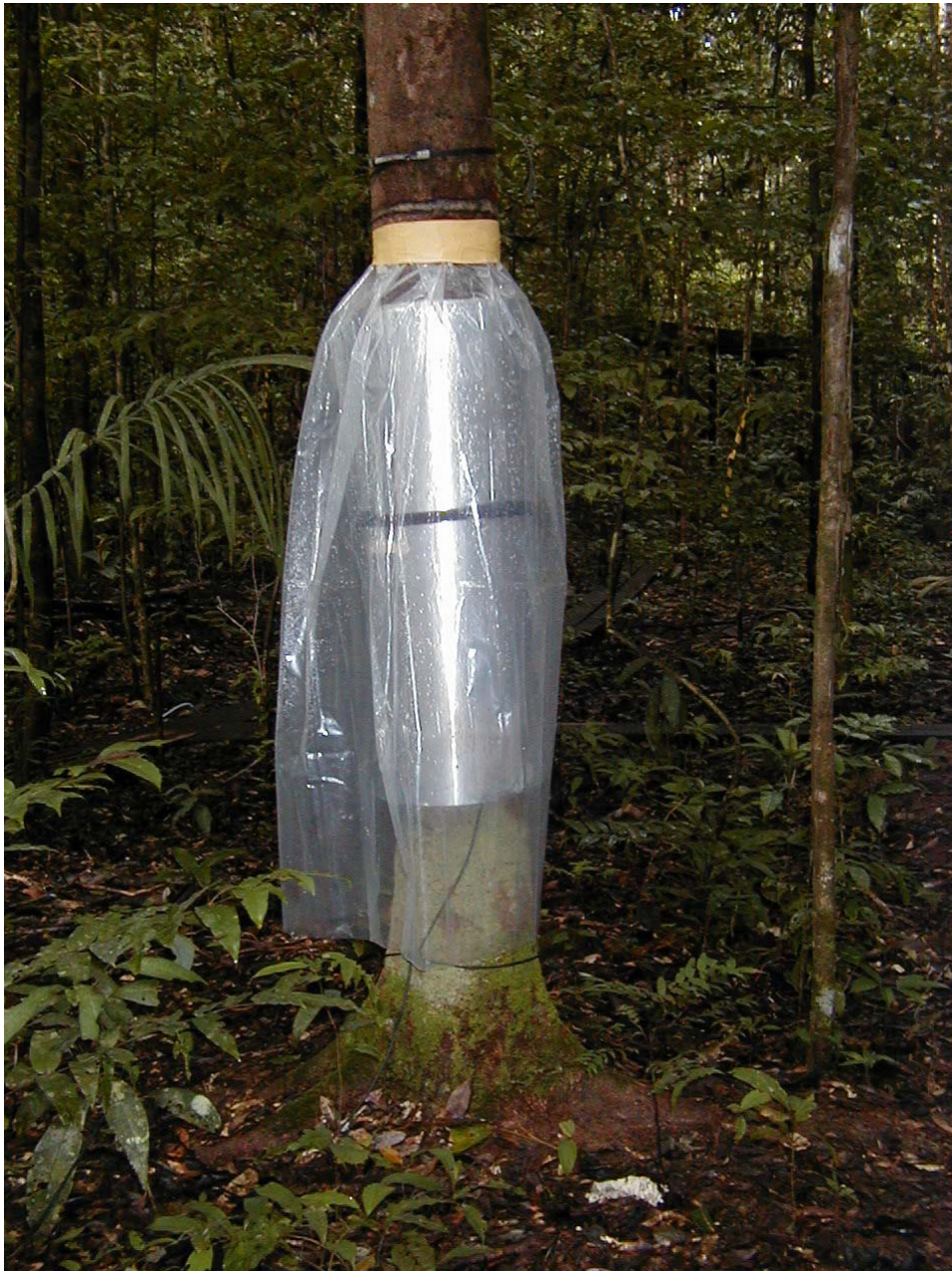
Figura 15. Árvore com a cobertura confeccionada em alumínio e plástico, para a proteção dos sensores de fluxos de seiva à ação das intempéries climáticas
