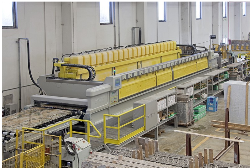
Figura 7 - Politriz automática – 18 cabeças (Gaspari Menotti).
