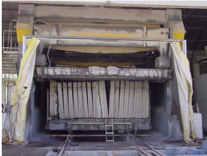
Figura 4 – Tear italiano JS 380, com chapas recém-serradas em seu interior
