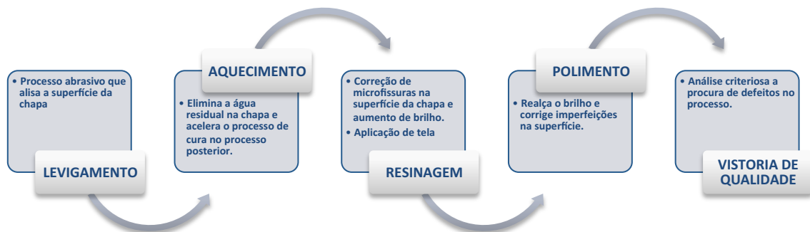
Figura 8 – Processo produtivo do polimento de chapas (Etapas do polimento)
