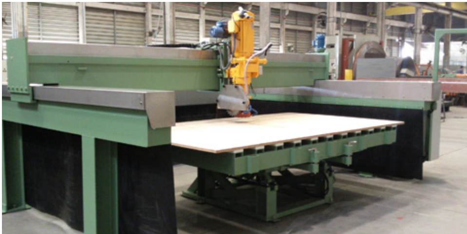
Figura 9 – Imagem da serra ponte efetuando corte em chapa de granito
